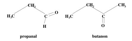
Fig. 3.18 An alkanal and an alkanon.
